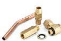
13 Комплект дополнительного охлаждения, используемый, когда температура входящей воды превышает 25°C или расход воды на выходе из машины меньше 5 л/мин
